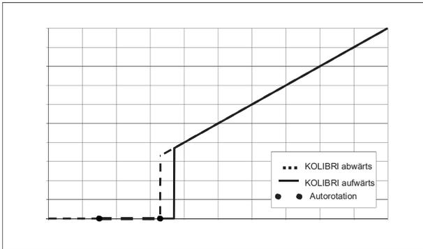
Der Heli Modus arbeitet mit einer echten Drehzahlregelung (Governor). Unabhängig von der Belastung wird die Motordrehzahl konstant gehalten, solange Akku- und Motorleistung dies zulassen. Der Regler lernt alle Parameter der Programmierung, wie das Verhältnis von Drehzahlvorwahl am Sender und Rotordrehzahl bei jedem Anstecken des Akkus neu ein.
