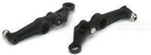
Blade Pitchkompensatorhebel : Blade 400
