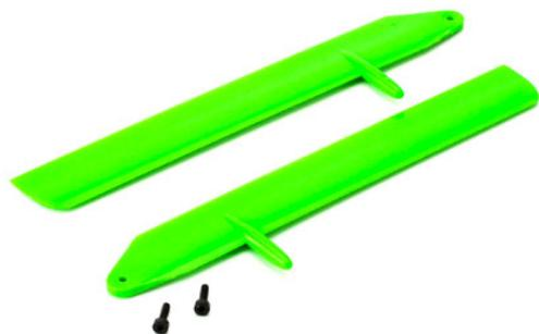
Blade 130X: Blade Fast Flight Hauptrotorblätter Set Gr. 1/2n
