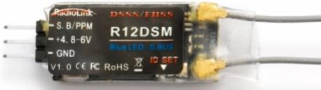
12-Kanal-Miniatur-2,4-GHz-FHSS/DSSS-Empfänger für Radiolink AT9S- und AT10II-Sender mit umschaltbarem S-BUS- oder PPM-Serien-Ausgang. Ideal für Multikopter. Abmessungen 30x15x5mm, 2,5g. Volle Reichweite.
