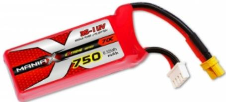
LiPo-Akku-Set ManiaX mit Belastbarkeit 70/140C, Laden 1-3C, max. 5C. 3-Zellen-Pack 3S 11,1 V 750 mAh, Abmessungen: 60x24x24 mm, Gewicht 67 g, XT30 + JST-XH-Balancerstecker. Ideal für den Minihubschrauber OMP M2 EVO.
