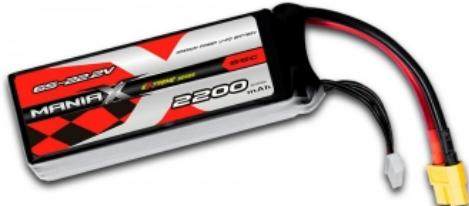
LiPo-Akku-Set ManiaX mit Belastbarkeit 55/110C, Laden 1-3C, max. 5C. 6-Zellen-Pack 6S 22,2 V 2200 mAh, Abmessungen: 110x34x52 mm, Gewicht 372 g, XT60 + JST-XH-Balancerstecker.
