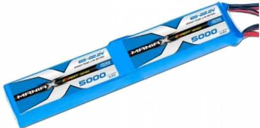
LiPo-Akku-Set ManiaX mit Belastbarkeit 45/90C, Laden 1-3C, max. 5C. 12-Zellen-Pack 12S 44,4 V 5000 mAh, Abmessungen: 310x48x50 mm, Gewicht 1620 g, JST-XH-Balancerstecker.
