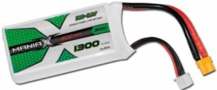
LiPo-Akku-Set ManiaX mit Belastbarkeit 30/60C, Laden 1-3C, max. 5C. 3-Zellen-Pack 3S 11,1 V 1300 mAh, Abmessungen: 75x34x22 mm, Gewicht 104 g, XT30 + JST-XH-Balancerstecker.
