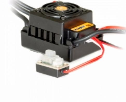
Programmierbarer, wasserdichter, sensorloser AC-Regler für Automodelle. Für Motoren mit 7 und mehr Windungen (Dauerstrom 50A), Stromversorgung 4-9NC/2-3 LiPO-Zellen, Gewicht 90g, BEC 6V/3A, Abmessungen 48,5x38x32mm mit Lüfter.
