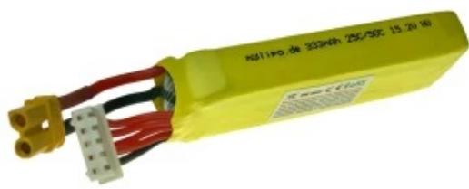
ACHTUNG HV Lipo LADESCHLUßSPANNUNG 4,35V
