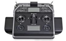
Die Graupner Fernsteuerung mc-28 HoTT ist ein Pultsender fi¿½r den fortgeschrittenen Modellsportler. Die mc-28 eignet sich fi¿½r nahezu alle Modelle und bietet Features die auch Funktionsmodellbauern an Land und auf dem Wasser gerecht werden. 16 Steuerfunktionen, 120 interne Modellspeicher, integrierte Telemetrie und Sprachausgabe sowie die schnelle und sichere bi-direktionale i¿½bertragung der Graupner HoTT 2,4 GHz Technologie, machen die mc-28 zu einem wahren Allrounder.
