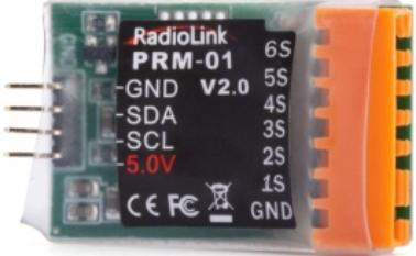
Telemetrie-Modul für Spannungsmessung von 1S bis 6S Lithium-Antriebsakkus. Für Radiolink-Sender R9DS und R12DS. Der Akku wird mit Hilfe des Balancersteckers (JST-XH) angeschlossen.
