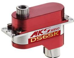
Das DS65K ist ein Meilenstein in der Servogeschichte. Mit gerade einmal 6.5g ist es sehr leicht und besitzt dennoch ein Vollmetall-Gehäuse sowie Metallgetriebe. Auch Stellkraft und Stellgeschwindigkeit suchen ihres gleichen. Es ist das ideale Servo für Modelle der F3K Klasse.
