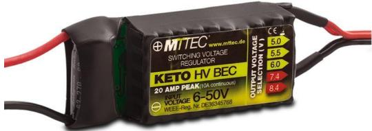
Das MTTEC KETO HV BEC V2 ist ein zuverlässiges und leistungsfähiges HV BEC der neusten Generation für 2-12S LiPo. Es verfügt über einen weiten Bereich an einstellbaren Ausgangsspannungen, und hält diese selbst unter starker Last sehr genau. Der angebrachte Kühler sorgt für den reibungslosen Abtransport der Wärme. In Verbindung mit einem leichten Luftstrom sind somit Dauerströme von bis zu 10A kein Problem.
