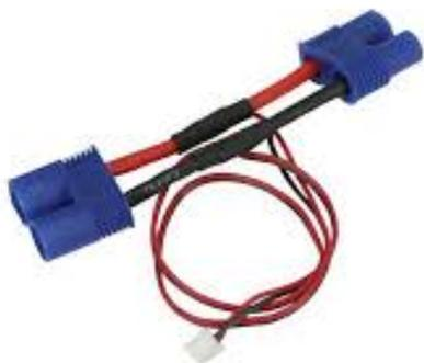
Spektrum Telemetriesensor für die Flugakkuspannung. Verfügt mit einem Steckeradapter mit EC3-Steckern. Kann zwischen Akku und Regler eingesteckt werden.
