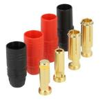
Diese hochwertige Goldkontaktsteckverbindung hat am Stecker einen Widerstand integriert, der den Blitz beim Verbinden des Reglers mit dem Akkus verhindert. Die Plastikh�lsen in rot und schwarz werden auf Stecker und Buchse geschraubt. Das ergibt eine sehr stabile Verbindung.
