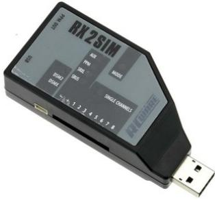
Es wird hierbei keine Schüllerbuchse am Sender benötigt. Lediglich ein zum Sender passender Empfänger mit den nötigen Kanälen muss vorhanden sein.
