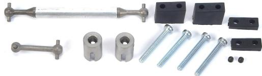
Kardanscheibe für Zwischengetriebe 4:1 zu Truck 56301.
