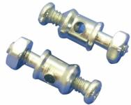
Dieser Gestängeanschluß ist für Drahtgestänge mit 1,8 mm Durchmesser geeignet, wie sie häufig in Parkflyern und Modellen verwendet werden. Durch die Klemmbefestigung ist eine stufenlose Einstellung der Gestänge möglich. Zum Festklemmen von Drahtgestängen auf dem Servohebel oder Ruderhorn.
