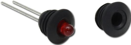
Für 3 mm LEDs aus Weich-Neopren, schmiegsam, robust, 1-teilig, schnell von zwei Seiten zu montieren. Diese Fassungen können mit allen auf dem Markt befindlichen LEDs bestückt werden, unabhängig von den Toleranzen. Einbaudurchmesser: 8 mm, Temperaturbereich -40 bis +150°C.
