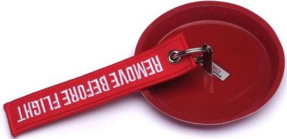
Wenn sich die Turbine eines Großen hubschraubers nicht in Betrieb befindet, wird diese mit einem Abgasdeckel geschützt. So wird verhindert, dass Fremdkörper in die Turbine gelangen.
